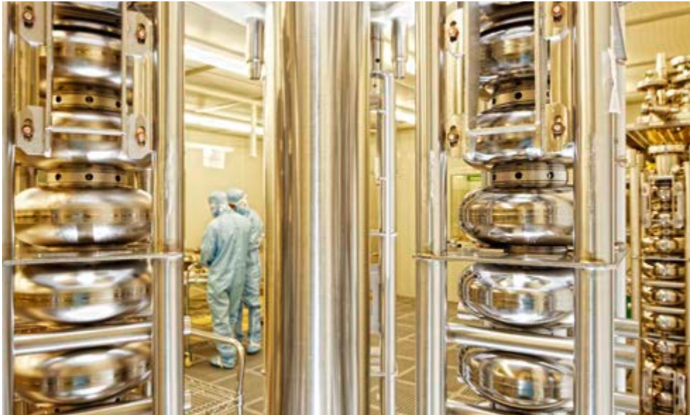
Herzstück der Freie-Elektronen-Laser FLASH und European XFEL sind Beschleunigerelemente aus dem Metall Niob. Sie werden in staubfreien Reinräumen gefertigt und arbeiten supraleitend bei einer Betriebstemperatur von minus 271 Grad Celsius.
